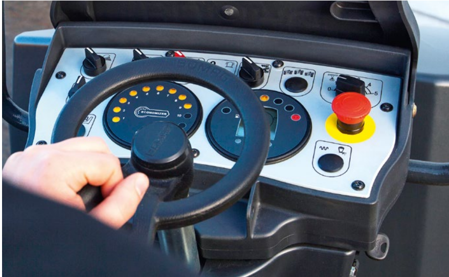
Große Schalter, ein kompaktes Lenkrad und eine übersichtliche Anordnung aller Bedienelemente vereinfachen jedem Bediener die Arbeit mit einer leichten BOMAG Tandemwalze.
