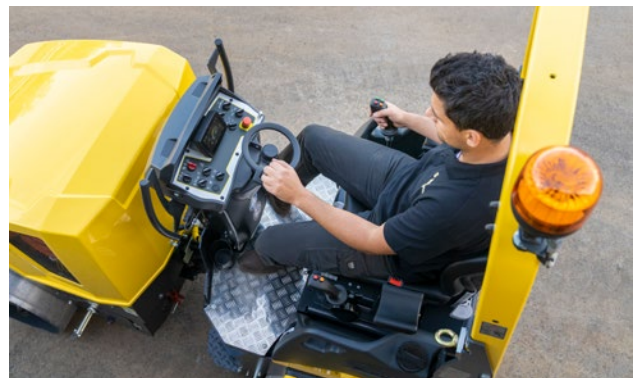
Große Schalter, ein kompaktes Lenkrad und eine übersichtliche Anordnung aller Bedienelemente vereinfachen jedem Bediener die Arbeit mit einer leichten BOMAG Tandemwalze.
