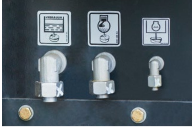
Intelligent: Betriebsmittel können von außen abgelassen werden.
