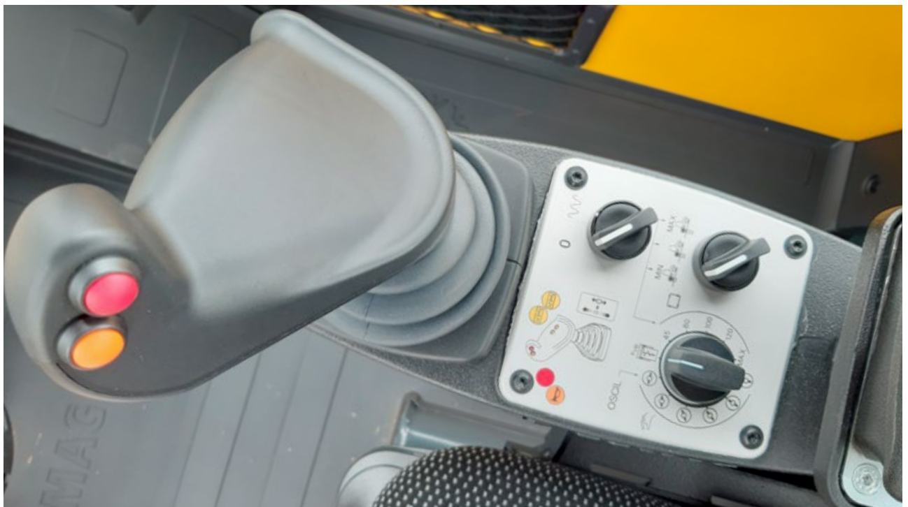
Alles im Griff durch den ergonomischen Fahrhebel mit integrierten Funktionen.
