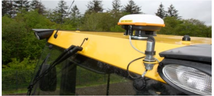
Die Präzision erhöhen: Die BOMAP GPS Antenne.
