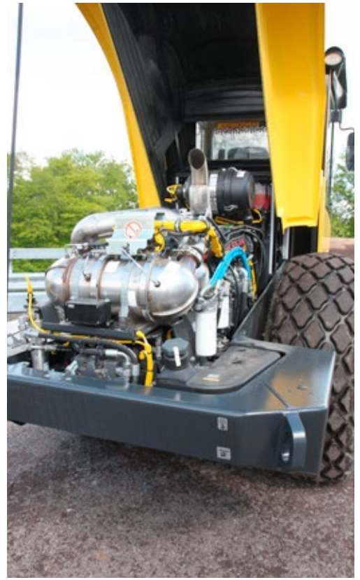
Alle Kabel sind vor Beschädigung geschützt.
