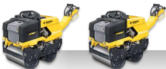
BW 65 Peso operativo: 720 kg Forza centrifuga: 25/13 kN Larghezza di lavoro: 650 mm BW 65 D Peso operativo: 740 kg Forza centrifuga: 25/13 kN Larghezza di lavoro: 650 mm
