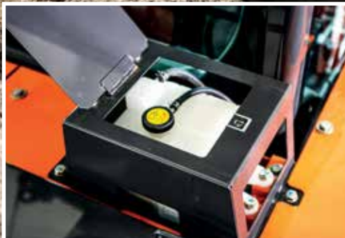
Der Ausgleichsbehälter im Kühlkreislauf verhindert, dass Motorteile überhitzen.
