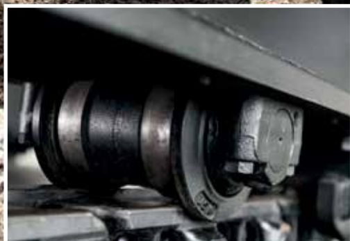
Das verstärkte Buchsenmaterial verbessert die Verschleißbeständigkeit.
