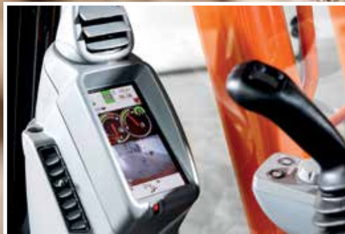
Der LCD-Monitor zeigt den Status und die Einstellungen der Maschine.
