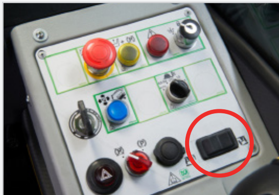
Steuerung des Niveaueingleichs auf dem Armaturenbrett vor dem Joystick
