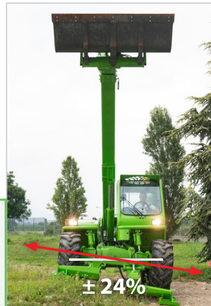
Kombinierte Wirkung von seitlicher Neigung und Abstützungen
