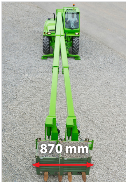
Seitenverschub des Oberwagens
