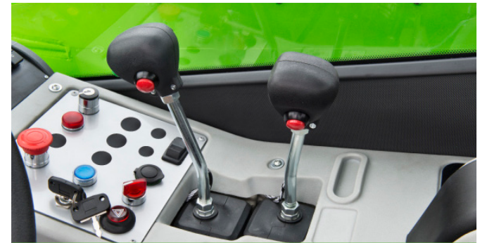
Ausführung mit 75 PS: Hebel zur Betätigung von Teleskoparm, Anbaurahmen, Werkzeugen und Seitenverschub des Teleskoparms
