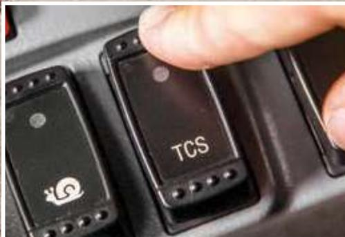
Il traction control system (sistema di controllo della trazione) contribuisce ad evitare lo slittamento dei pneumatici sul bagnato e su terreni innevati.
