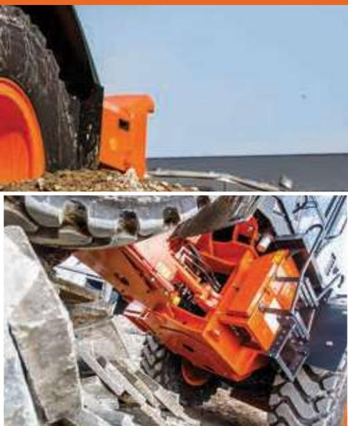
La copertura inferiore opzionale protegge ulteriormente la macchina.
